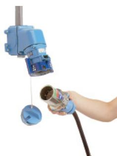
Aus dieser Wartestellung kann der Stecker durch eine Vierteldrehung nach links herausgezogen werden. Anschließend kann zur Abdichtung nach IP67 der Deckel angebracht und verriegelt werden.
