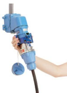
Wird der Ring an der Dose nach links gedreht, so wird der Stecker ausgeworfen und der Stromkreis ist unterbrochen. Der Stecker verbleibt in Wartestellung.
